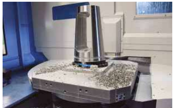
Lavorazione di particolare su piastra Zero Point Workpieces on Zero Point base plate
