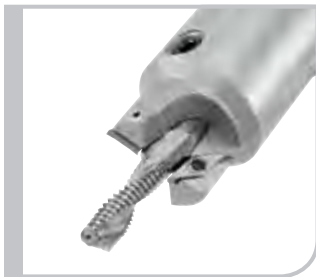
Kombinationswerkzeug mit Bohrgewindefräser M 12 2,5xD, IK Plansenk- und Anfasplatte
