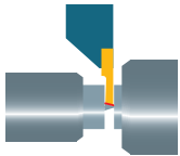
Отрезка с противопинделем
