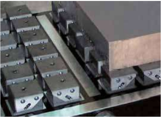
Espansioni polari - Chuck shoes
